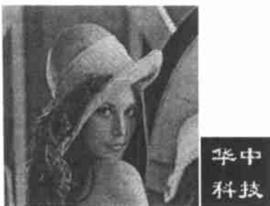
图 3 嵌入水印后的图像 wmLena (PSNR = 55.67) 及从中提取出的水印
