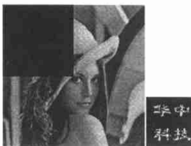
图 4 遭受剪切攻击后的 wmLena (PSNR = 33.20) 及从中提取出的水印
